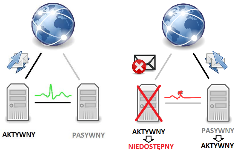
Ilustracja 1: Schemat obrazujący sposób działania klastra active-passive Źródło: Opracowanie własne
